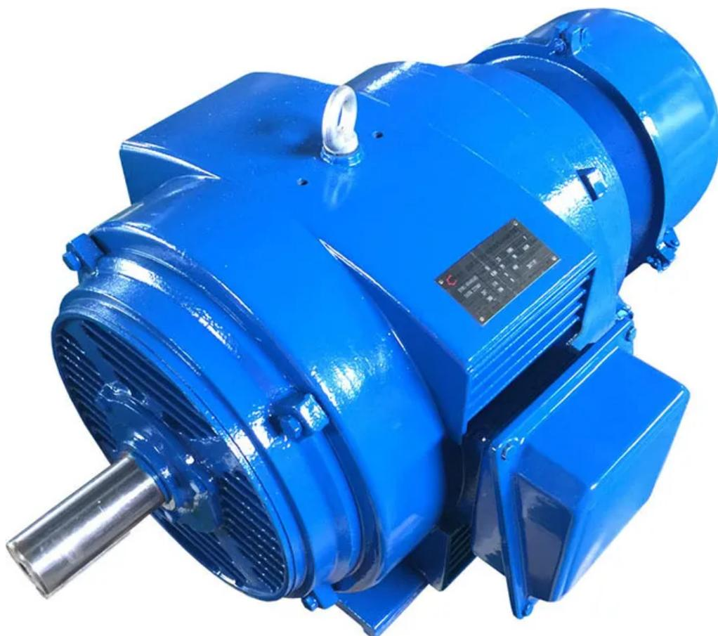
Электродвигатели асинхронные трехфазные с фазным ротором серии 5АНК предназначены для привода агрегатов с тяжелым, а также плавным ступенчатым пуском: металлорежущего, кузнечно-прессового, вентилирующего, компрессорного оборудования и т.д. Основные технические характеристики: Исполнение - закрытое, обдуваемое; Напряжение питания - 220В/380В, 380/660В (при частоте 50 и 60 Гц); Степень защиты базового исполнения - IP 23; Режим работы электродвигателей - S1-S8; Климатическое исполнение - У и Т.
